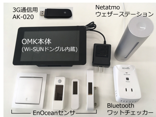
図 2: OMK のハードウェア構成の一例
