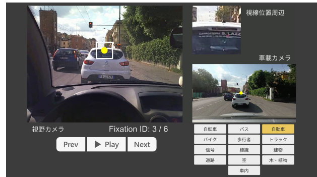
図4: 注視イベント抽出システムの作業画面
