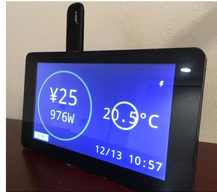
図 3: 「おうちモニタキット (OMK)」のディスプレイによる可視化
